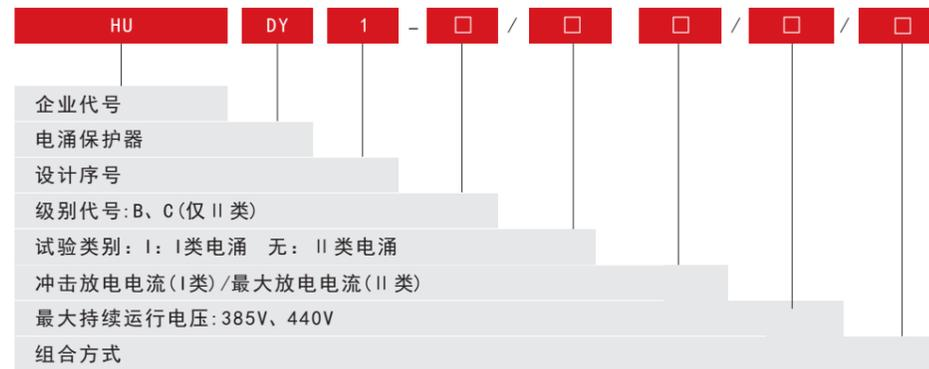
示例：最大放电电流为40kA、级别代号为C型、最大持续运行电压为交流385V的1P电涌保护器表示为 HUDY1-C/40kA/385V/1P。
