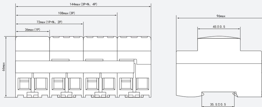
图 3、C型电涌保护器外形尺寸和安装尺寸
