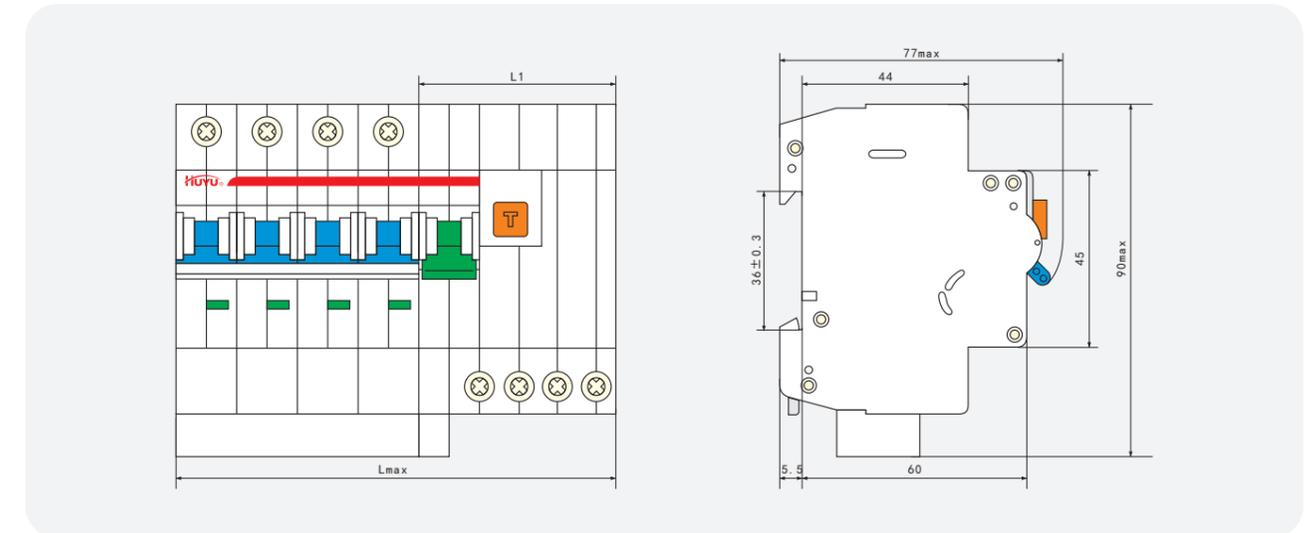
注：漏电断路器采用TH35-7.5型标准导轨安装
