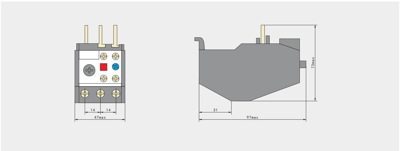
2、JRS2-12.5/F、25/F、32/F、45/F外形及安装尺寸图（mm）
